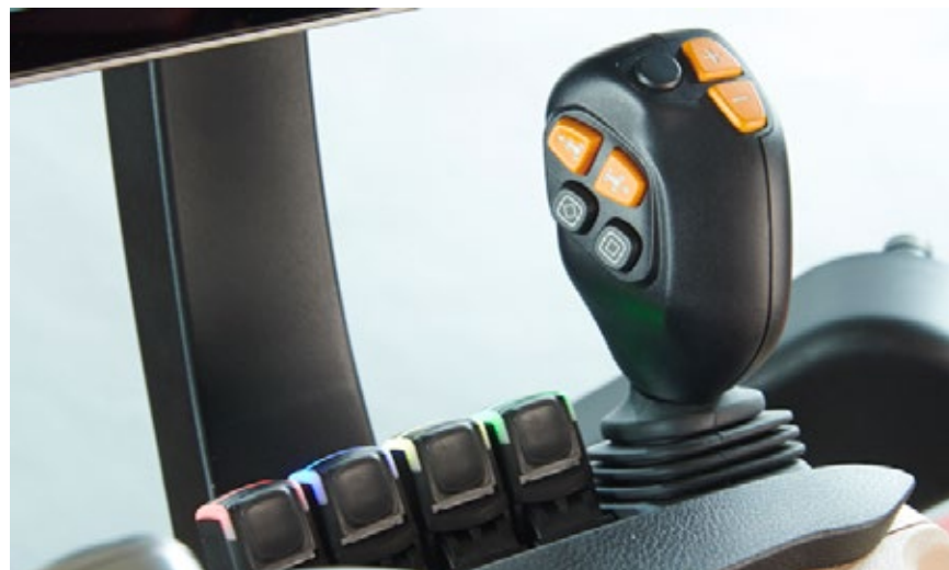
K ovládání hydraulických okruhů lze využít také joystick, který může být na přání integrován na loketní opěrce Multicontroller.
