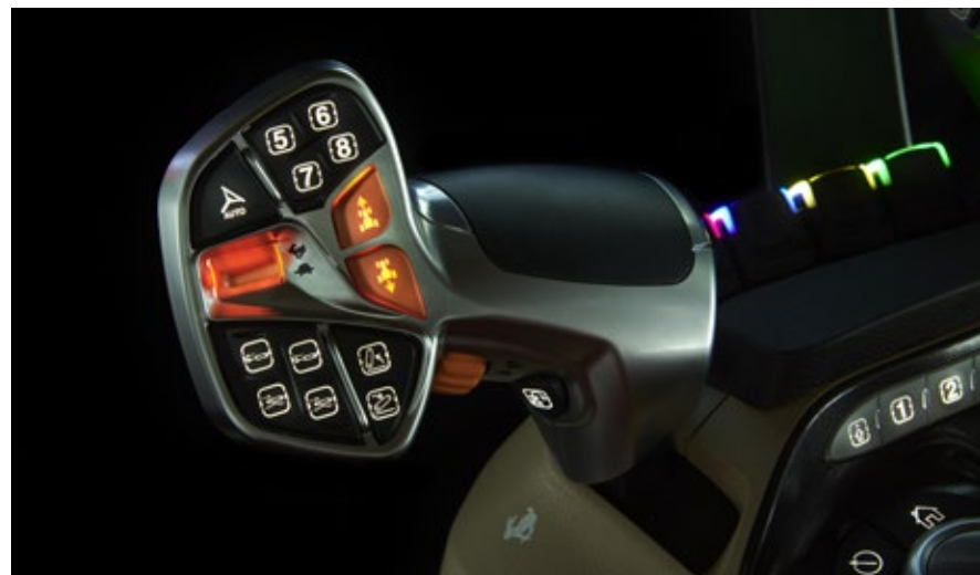
Pro snadné ovládání v noci jsou všechna tlačítka na ovládací páce podsvícena.
